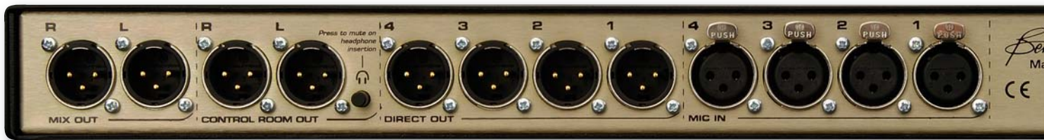
Auf der Rückseite sind neben den vier Direct-Ausgängen für vierkanalige Aufnahmen die beiden Stereoausgänge zum Abhören der Abmischungen installiert.
