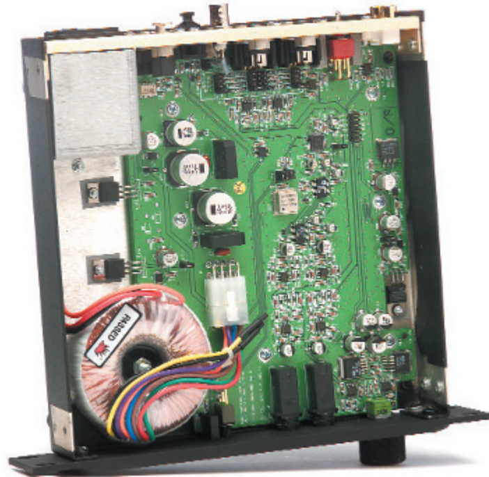
Die technischen Leckerbissen auf höchstem Niveau finden im DAC-1 auf einer SMD-Platine Platz
