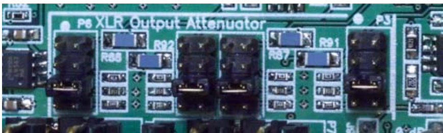
Foto 1 - Jumper zur Dämpfung des XLR-Ausgangspegels (P3, P4, P5 und P6)
